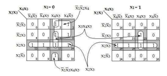
$F(x_1, x_2, x_3, x_4, x_5) = x_2x_3 + x_3x_4x_5 + x_1'x_2'x_4 + x_1'x_3'x_4x_5$
