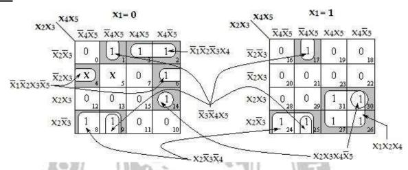
$F(x_1, x_2, x_3, x_4, x_5) = x_2x_3'x_4' + x_2x_3x_4x_5' + x_3'x_4'x_5 + x_1x_2x_4 + x_1'x_2'x_3x_5' + x_1'x_2'x_3'x_4$
