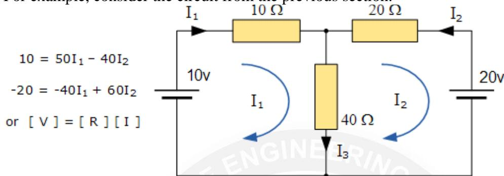
**Figure 1.4.2 Mesh Circuit**
