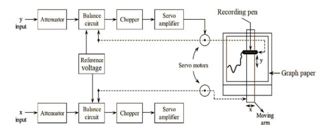
Fig. 5.5.1 Servo / X-Y Recorder
