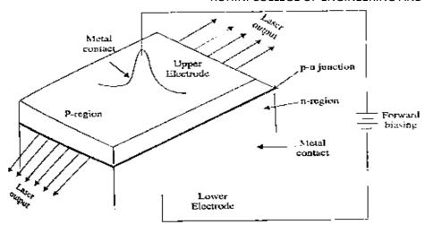
Fig 4.6.2. Laser Diode
